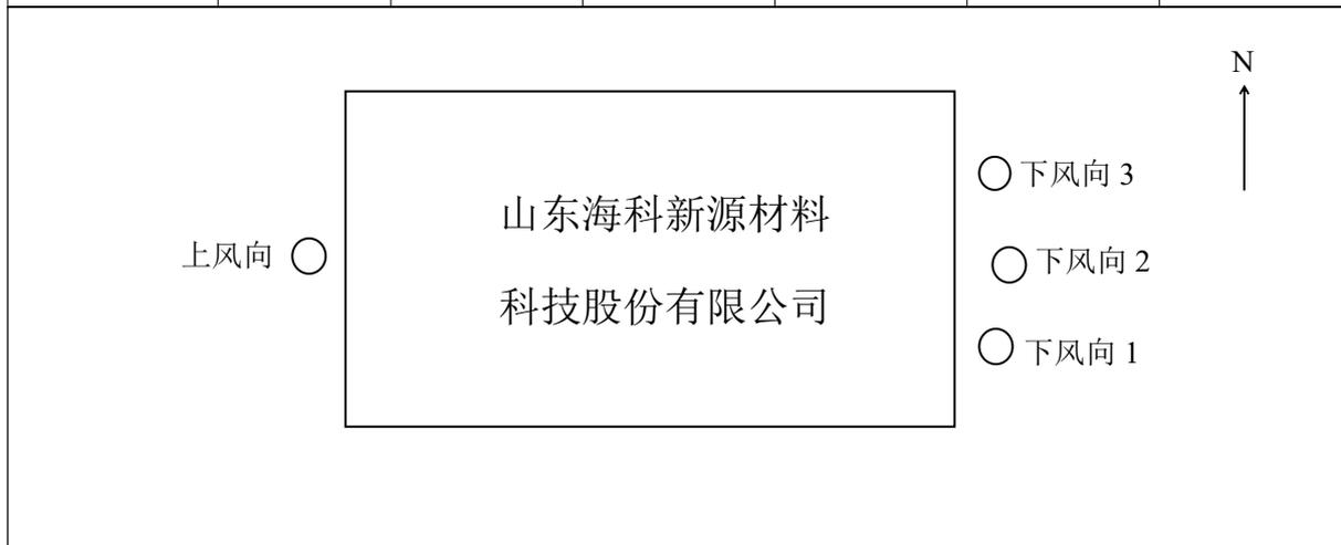
图1 无组织废气检测布点图
